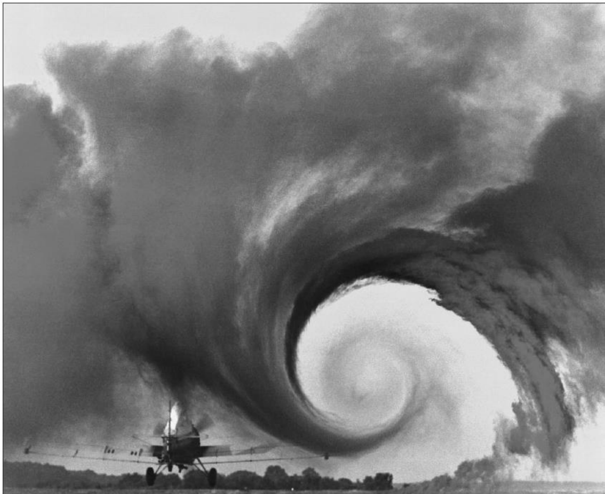
شکل ۱.۱۹ تجسم گردابه‌های نوک بال، که اندازه عظیم گردابه‌های تولید شده در طول مرحله برخاستن هواپیما را نشان می‌دهد. (ناسا)
